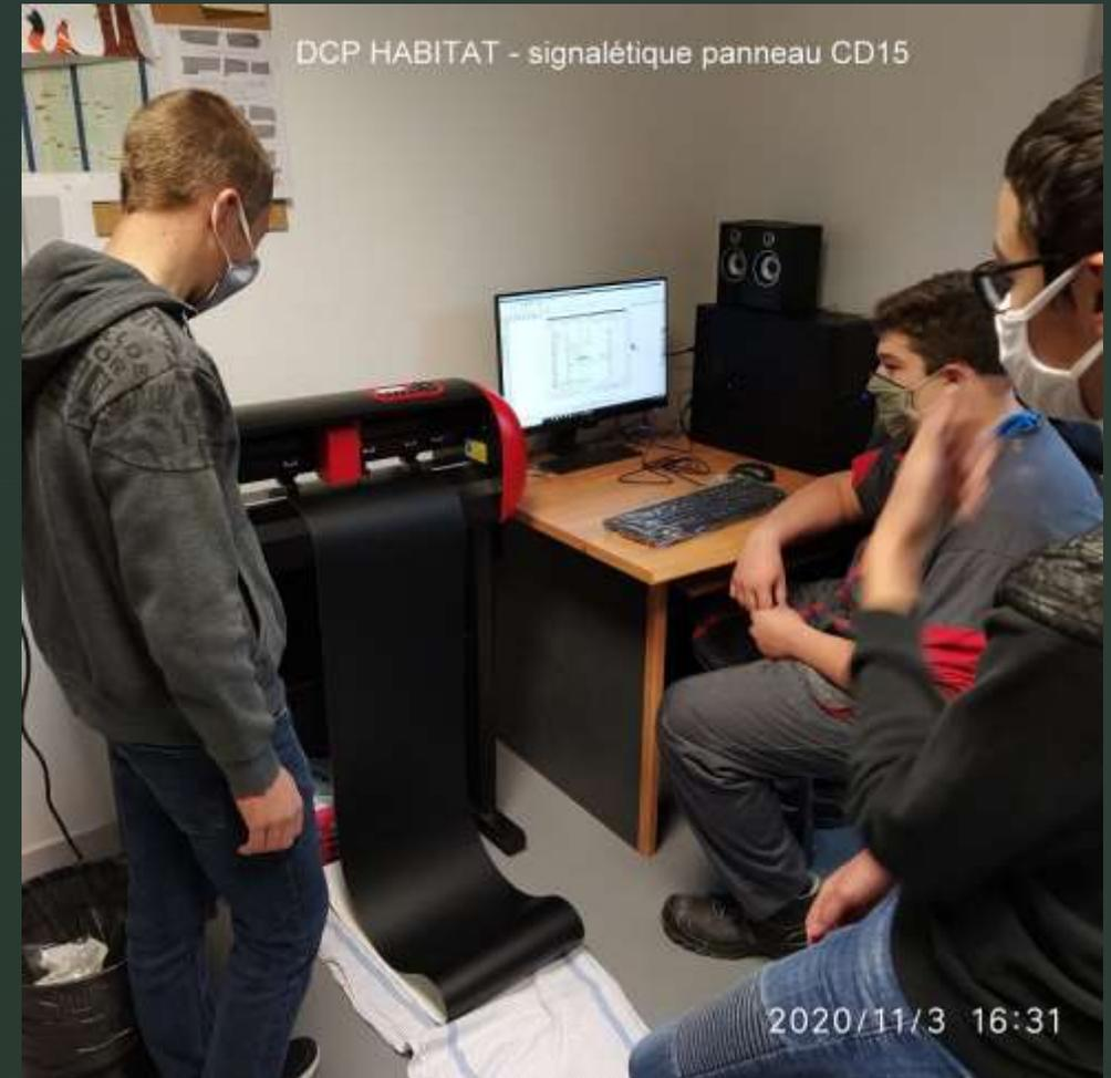
Découpe du lettrage à l'aide d'une machine de découpe assistée d'un logiciel de dessin
